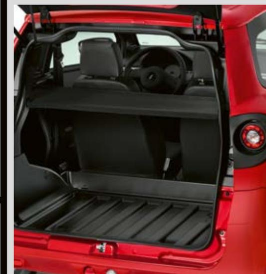
Le cache-bagages compartimente le coffre en toute discrétion et l'arrêt de charge bloque le chargement.
