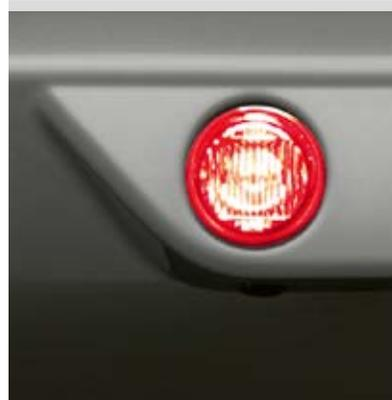
Feu de brouillard arrière pour plus de sécurité en visibilité réduite.
