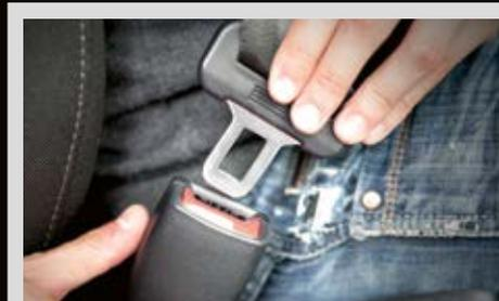
Les ceintures de sécurité des MINAUTO sont testées à pleine charge, sous un effort de traction de 5,4 tonnes, soit deux fois plus que ce qu'impose la législation (2,7 tonnes). Elles sont également conçues pour ne pas rester bloquées.
